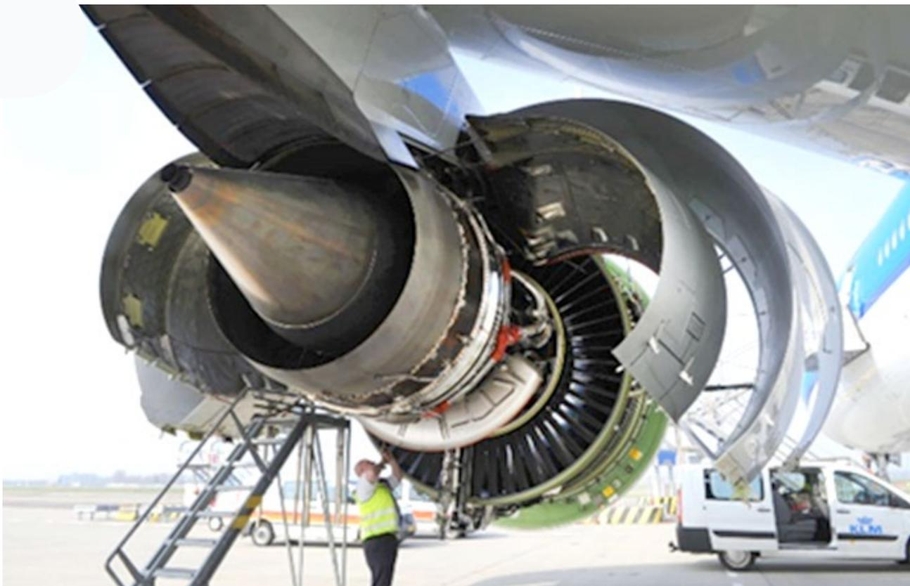
Figura 3. Turborreactor en avión en mantenimiento. Imagen tomada de: <https://jetnews.com.mx/funciones-la-turbina-avion/>
