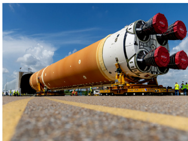
Figura 3. Zona central del cohete SLS (Doyle, 2024)
