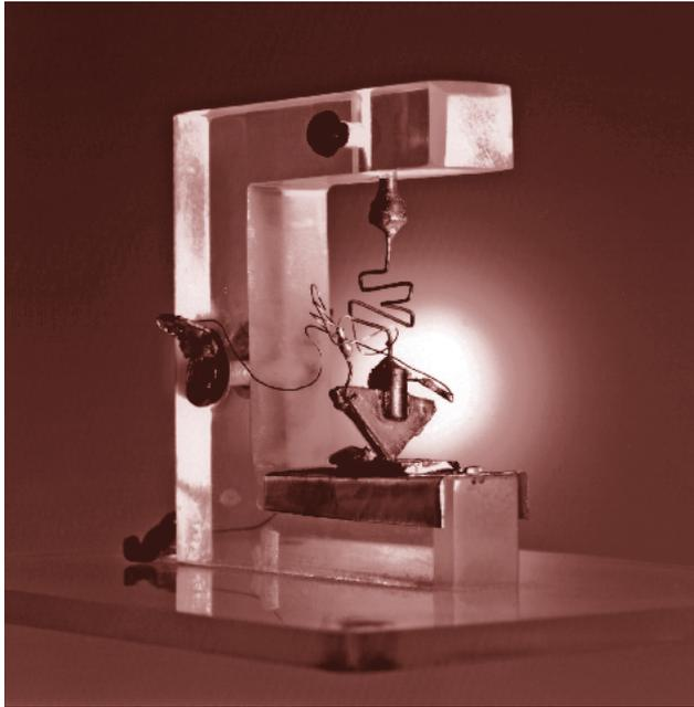
Figura 3. Primer transistor fabricado por los laboratorios Bell en 1947. Imagen tomada de: [https://memorial.bellsystem.com/bellabs\\_transistor.html](https://memorial.bellsystem.com/bellabs_transistor.html)
