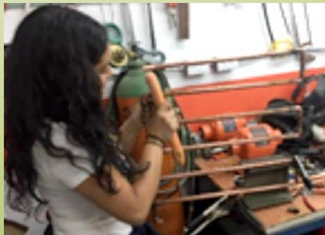
Soldadura de la tubería en forma de serpentina
