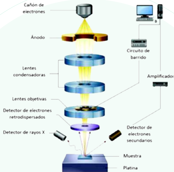
Figura 1. Configuración de un SEM. Tomada de referencia 2.
