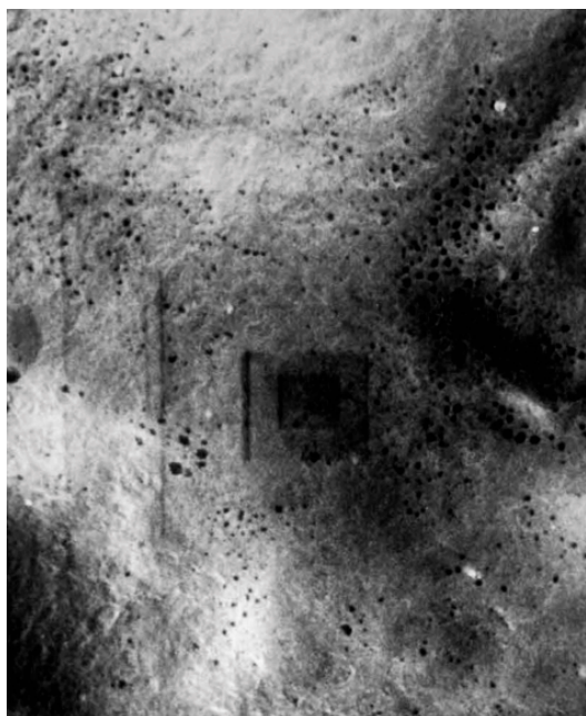
Figura 1. Imagen en que se observa el daño causado a un espécimen mal preparado para SEM.
