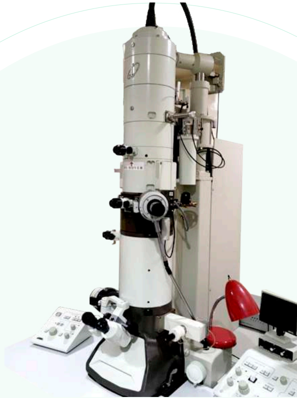
Microscopio electrónico de transmisión. La columna central contiene lentes electromagnéticas y los electrones se producen en la parte superior del instrumento.
