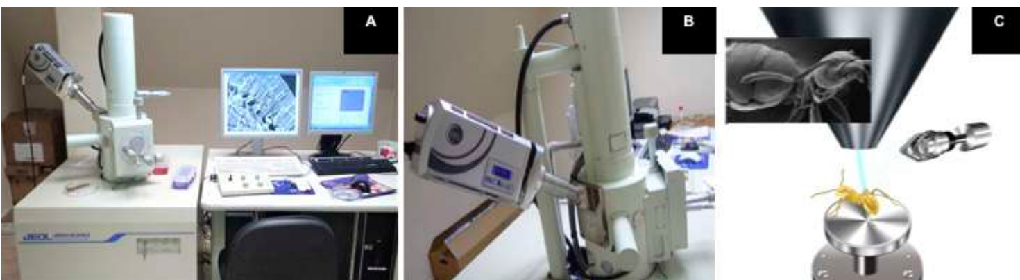
Figura 1. Microscopio Electrónico de Barrido convencional JSM 5690 (JEOL, Japón), alto vacío, con EDS (INCAx-act, Oxford Instrument) acoplado. Resolución 3 nm. A y B (MEB de la Unidad de Microscopía Electrónica, COLPOS, Montecillo); C. Formación de la imagen en un MEB por e^- secundarios (imagen C tomada de https://myscope-explore.org/2_9_howistheimagemade.html ).
