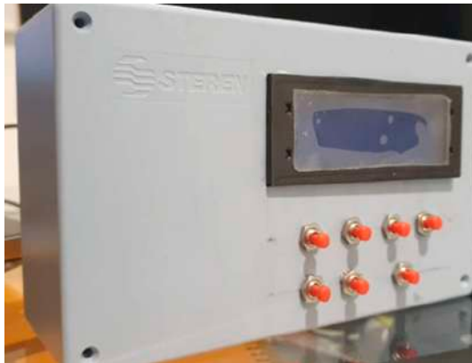
Figura 10. Implementación física del generador de pulsos.
