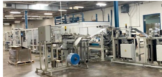
Figura 4. Máquina Widmann para encuadernación de carpetas con sellado ultrasónico. Fotografía cortesía de Gabriel Rihan de SAMSILL de Mexico, S.A. de C.V.
