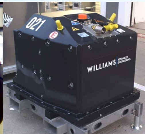
Batería homologada Fórmula E Generación 3, construida por Williams Advanced Engineering Cortesía de Electric Motor News
