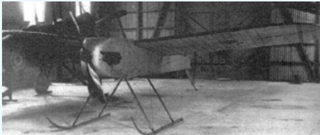
Figura 2. Primer avión no tripulado controlado por radio
