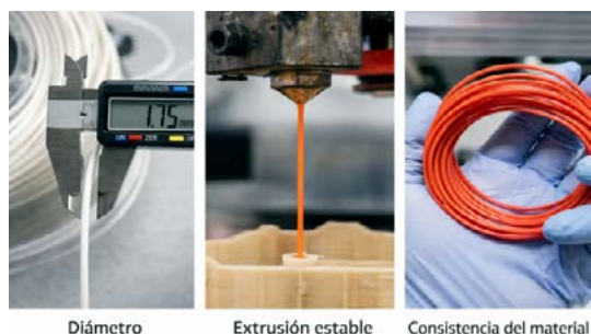
Figura 2. Parámetros críticos de control de calidad del filamento reciclado para impresión 3D. Fuente: IA.
