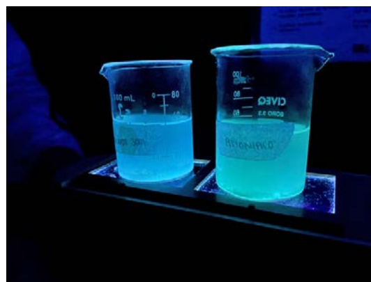
Figura 1. Muestras de puntos cuánticos de carbono bajo radiación UV. Fuente: Elaboración propia.
