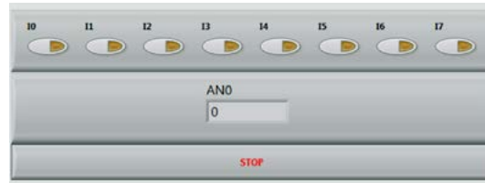
Figura 6. Panel frontal del sistema de 1 entrada analógica y 8 salidas digitales.
